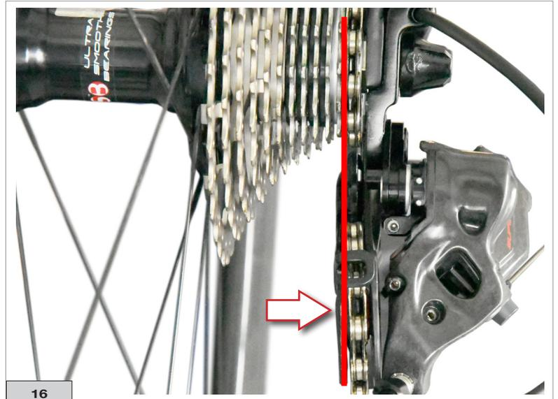
**!** Im Falle des Rahmens mit innen verlaufender Kabelführung auch sicherstellen, dass das Schaltkabel und das Umwerferkabel sich nicht berühren: eventuell das Umwerferkabel vollständig lockern und unter diesen Bedingungen die Funktion des Schaltwerks prüfen.
