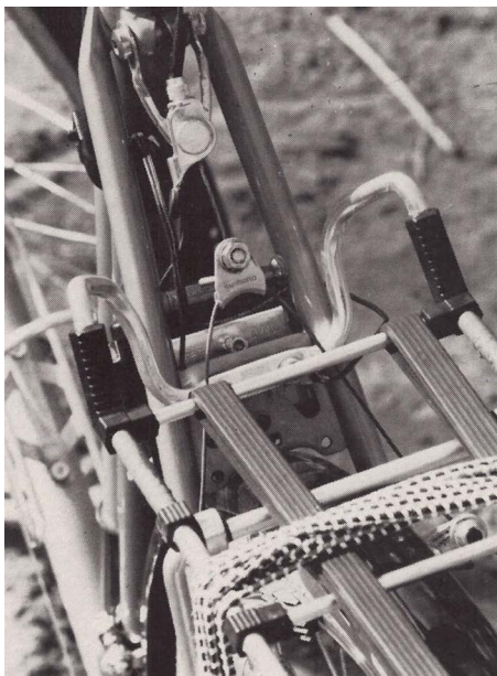
Die Befestigungsmöglichkeiten für Esge- und Blackburn-Träger.
