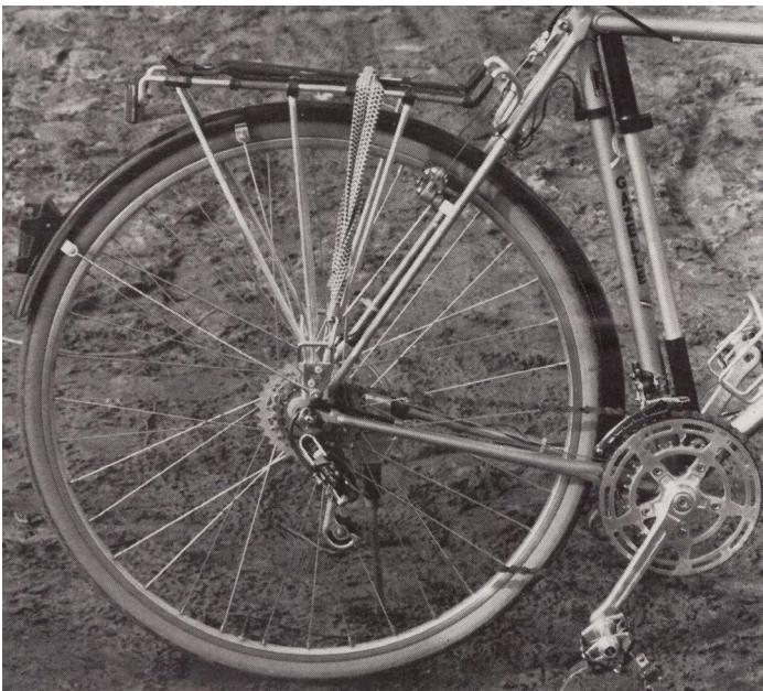
Die Extremübersetzung (Stronglight 99, Regina Oro) mit Duopar-Schaltung.
