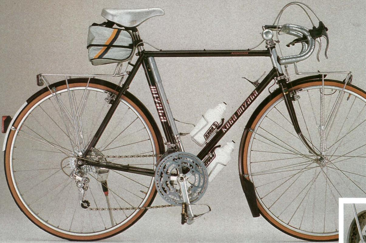
Mit bekannter Gründlichkeit hat KOGA MIYATA diese Reismaschine konstruiert; für sie sprechen die hohe Material- und Verarbeitungsqualität und das sinnvolle Zubehör. Beispiele: ein elegant gebogener Extra-Steg für die Stellschraube des hinteren Bremszuges und ein angelöteter Kettenhalter. Anlötteile für einen Front-Gepäckträger (Lowrider) sind vorhanden. Vorteil des Rollendynamos (unten): extrem leichter und ruhiger Lauf.
