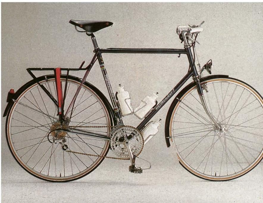
Sprint Classic-Komponenten von Gipiemme ausgerüstet, weist als Reiserad-Attribute den langen Radstand, je zwei Schutzbleche und Gepäckträger sowie die Lichtanlage auf.
