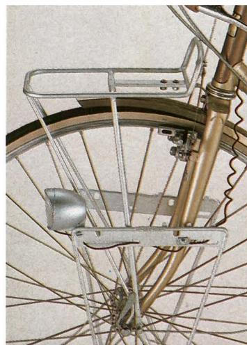
Ein leicht aushakbarer Bremszug ersetzt außerdem den Schnell-auslöser. Leichte Schwachpunkte sind die kleine Pumpe und der einfache Seitenständer. Links: An den tief angebrachten Seiten-trägern (Lowrider) kann man das Gepäck sehr niedrig und deshalb günstig für den Schwerpunkt anbringen.
