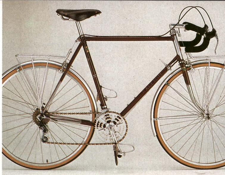
**Einen Super-Rahmen fertigt RALEIGH: Reynolds 531 C Rohre, sauber verarbeitet und an Gabel und Hinterbau teilweise verchromt. Außerdem kann das Rad als einziges mit Original-Blackburn-Gepäckträgern aufwarten. Lichtenlage und Ständer fehlen, können nach individuellem Geschmack aber nachgerüstet werden. Offen blieb, warum Raleigh auf die sonst üblichen Cantilever-Bremsen verzichtet.**
