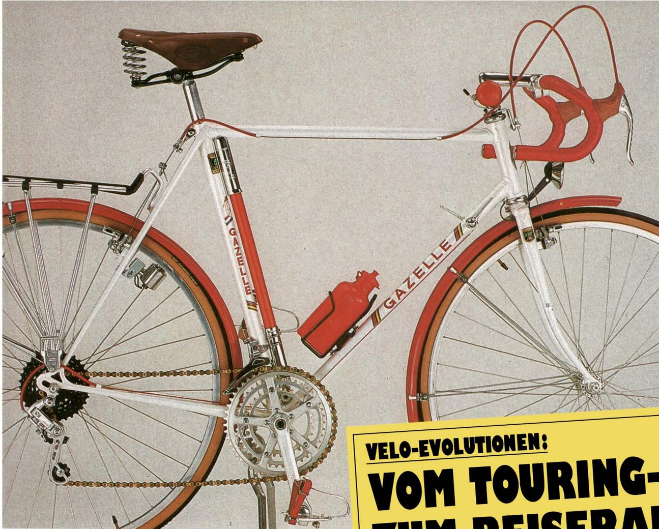
Sauber verarbeitete Reynolds 531 C Rohre und ein langer Radstand kennzeichnen den GAZELLE-Rahmen. Er besitzt Anlötteile sowohl für einen vorderen Gepäckträger wie auch hinten für ein nach Blackburn-Prinzip gebautes Lastgestell. Sieben verschiedene Farben stehen zur Wahl, die lieferbaren Rahmehöhen reichen von 50 bis 60 cm. Die Ausstattung dieses „Ur-Reise-Rahmens“ stammt von Rose und entspricht der hohen Rahmenqualität.
