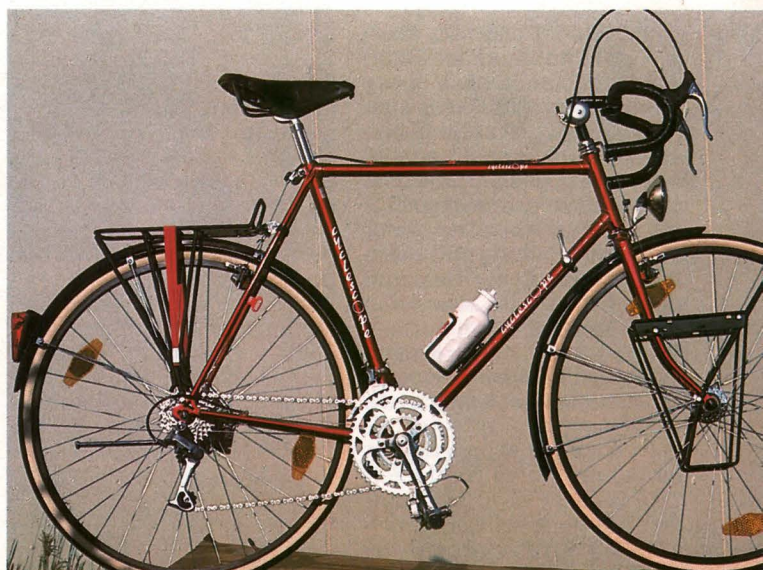
Oben: Ebenfalls aus dem renommierten Chrommolybdän-Werkstoff 25 CrMo 4 von Mannesmann besteht ein Reiserad, das der Spezialversender Bicycle's aus Bielefeld unter dem Namen »Cyclescope« vertreibt. Es ist komplett mit Licht (auch den gesetzlich vorgeschriebenen Speichenstrahlern), Schutzblechen, zwei Gepäckträgern und Klingel ausgestattet, bietet einen gefederten Sattel und gute Allround-Ausstattung zu einem recht akzeptablen Preis.
