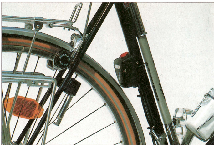
Weinmann-PBS-Bremse, stabiles Rahmenschloß, Standlichtanlage (Villiger)
