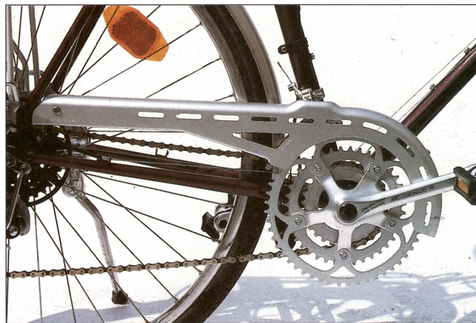
Drei Kettenblätter, Umwerfer, Kettenkasten: Zuviel auf einmal, der Kasten mußte weg (Utopia)
