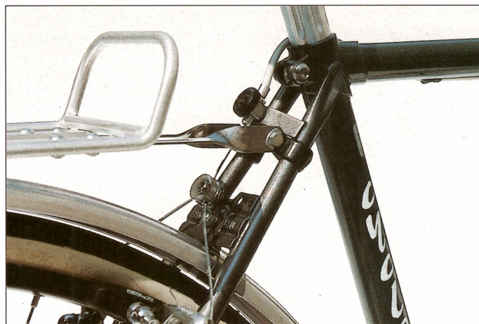
Schellenbefestigung für den Blackburn-Träger trotz vorhandener Platte für ESGE-Träger (Cyclescope)
