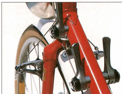
Ungünstige Anbringung der Dynamo-Fernbedienung in zu großer Nähe der Schalt- hebel (Lieke & Schefzyk)
