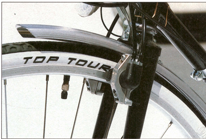
Deutsche Wertarbeit: Conti-Reifen Top Touring und Hydraulikbremse von Magura (Patria)
