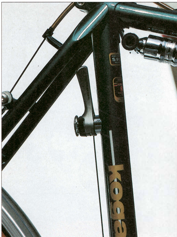
Schalthebel als Dynamofernbedienung (Koga Miyata)
