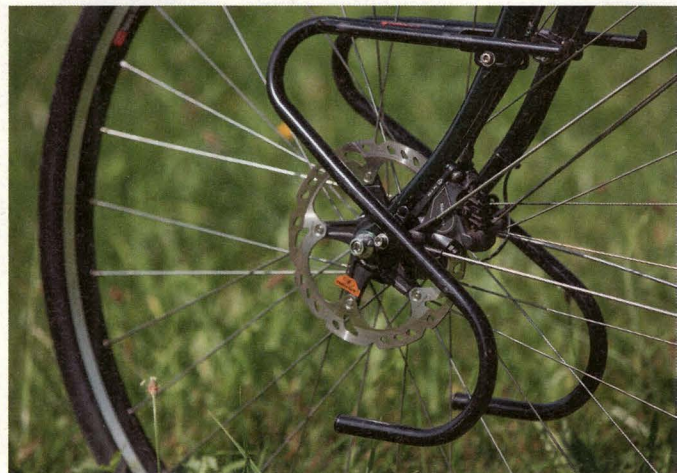
Überzeugend: Die 160er Scheibe vorn arbeitet perfekt, der Tubus-Träger ist ein sinnvolles Teil für Reisende mit viel Gepäck.
