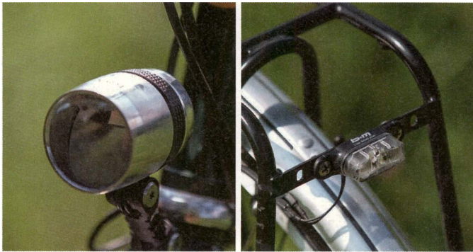
Taghell: In Verbindung mit dem SON-Nabendynamo leuchten die Front und das Heck zuverlässig und effektiv.
