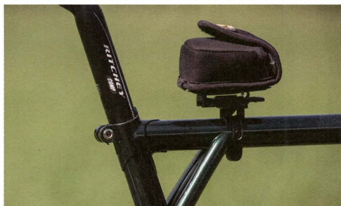
Filigran und schön: Der Diamantrahmen mit handgelöteten Muffen und Columbusrohr weiß Rad-Connaisseure zu begeistern.
