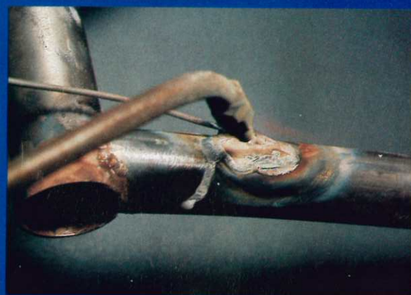
Bildfolge links, oben und rechts: Bremszug-Verlegung im Oberrohr. Dazu die Stellen ausmessen und markieren, wo der Zug ins Oberrohr eintauchen soll. Dann ankörnen, senkrecht einbohren und den Bohrer vorsichtig in Zugverlaufrichtung neigen. Loch entgraten (!), Innenröhrchen einführen. Enden der dünnen Rohre mit Aufsatz-Röhrchen verlöten, dabei Zugelänge mit Tildraht verschließen und nacharbeiten.
