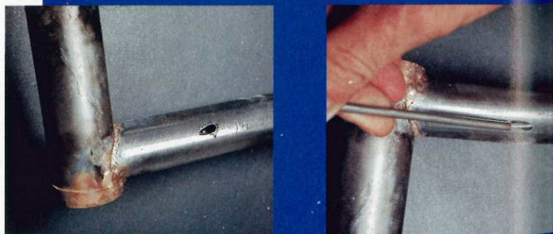
Bildfolge links, oben und rechts: Bremszug-Verlegung im Oberrohr. Dazu die Stellen ausmessen und markieren, wo der Zug ins Oberrohr eintauchen soll. Dann ankörnen, senkrecht einbohren und den Bohrer vorsichtig in Zugverlaufrichtung neigen. Loch entgraten (!), Innenröhrchen einführen. Enden der dünnen Rohre mit Aufsatz-Röhrchen verlöten, dabei Zugelänge mit Tildraht verschließen und nacharbeiten.
