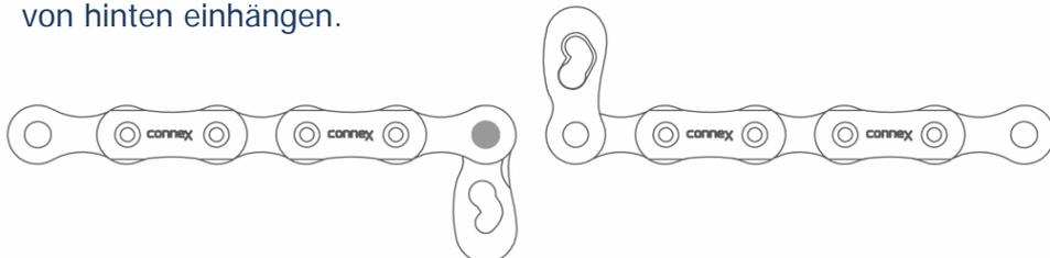
3. Kettenenden im Bereich der Bohrung übereinander führen.
