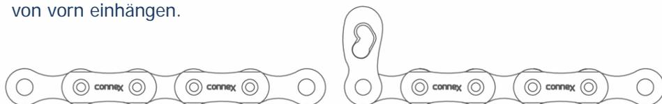
2. Die andere Linkhälfte in den vom Schaltwerk kommenden Kettenstrang von hinten einhängen.
