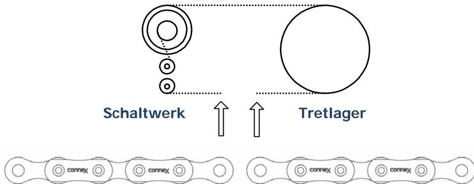
1. Eine der baugleichen Linkhälften in den vom Tretlager kommenden Kettenstrang von vorn einhängen.
