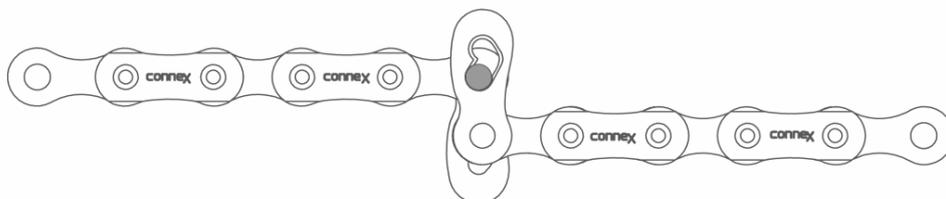
4. Durch Strecken der Kette gleiten die Laschen in den Nuten der Bolzen ungerastet in ihre Endposition.
