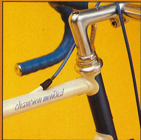
Bei dem Gazelle 753 Super Record verläuft das Bremskabel durch das Oberrohr.
