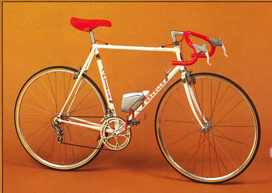
Die Schaltgriffe sind oben auf das Unterrohr, also ausserhalb der Luftströmung, montiert.
