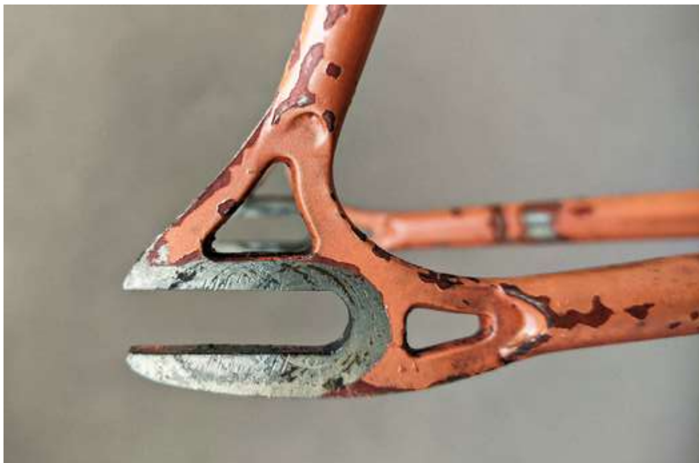
Pendino pista Zeus e lavorazione a coda di rondine
