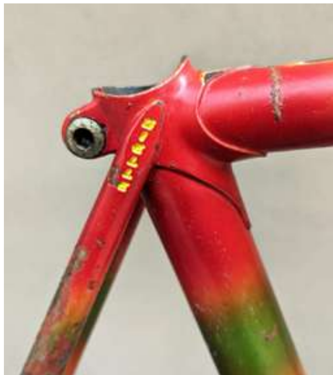
Nodo sella con pendino pantografato
