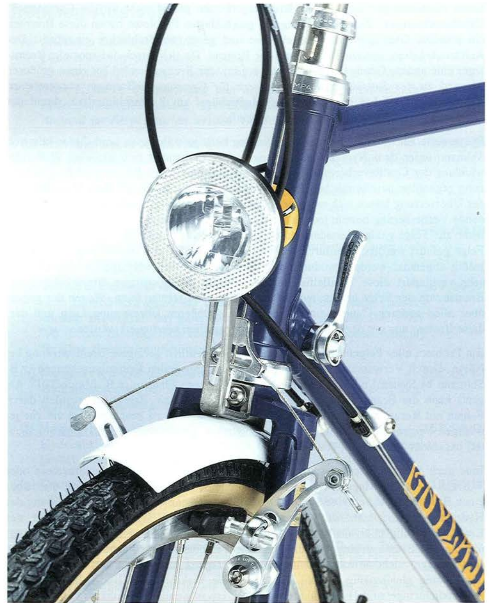
Reiserad GUYLAINE WL: Steuerkopfbereich mit Steuersatz Campagnolo Con-tax mit GUYLAINE Bremszuggegenhalter, Bremsen Campagnolo Record OR mit Shogun Zugdreieck, Scheinwerfer Union U9430H (vorn am Unterrohr Fernbedienungshebel für Walzendynamo)
