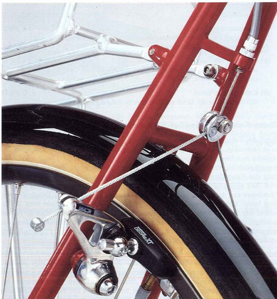
Reiserad WL: Sattelstrebenbereich mit Gepäckträgerbefestigung und Bremszuggegenhalterbügel mit Einstellschraube, Bremsen Deore XT M732
