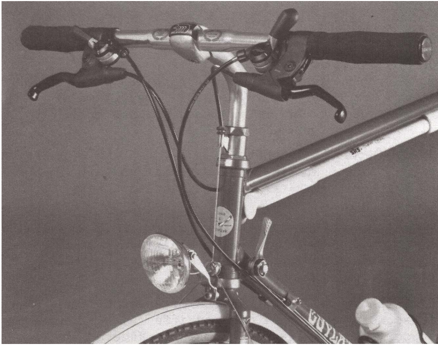
Oben: Vorbau TTT Mountain Top, Lenker TTT Plane mit Dauerschalthebeln und 2-Finger-Bremsgriffen Shimano Deore XT;
