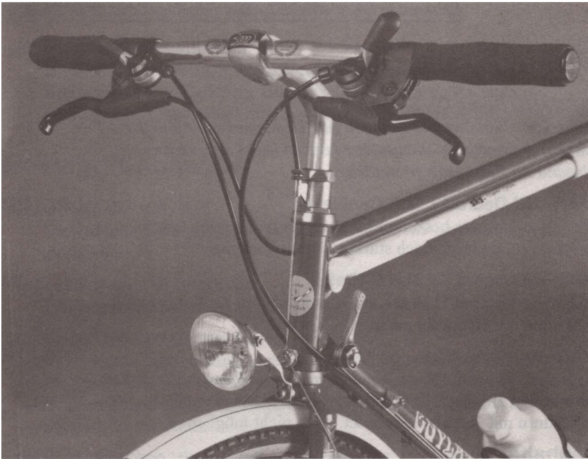
Oben: Vorbau TTT Mountain Top, Lenker TTT Plane mit Dau- menschalthebeln und 2-Finger-Bremsgriffen Shimano Deore XT;
