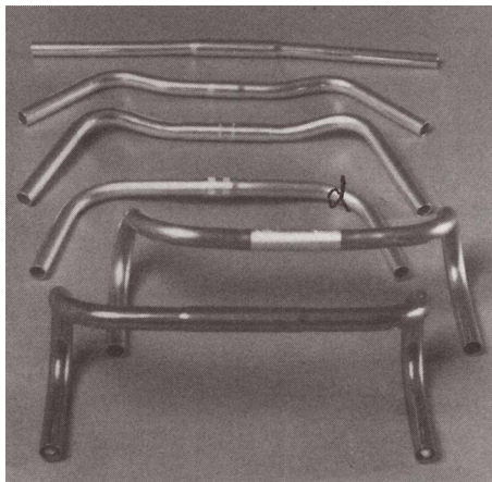
Lenkerformen (von oben nach unten): TTT Plane, TTT Valencia, CP Sportbügel, SR Sportbügel, Randonneur, TTT Competizione
