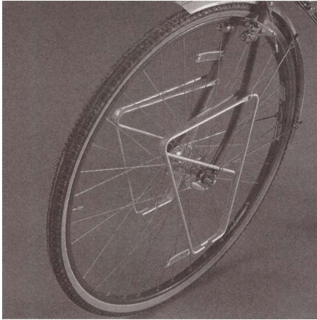
Low Rider CL-1 von Blackburn: Durch die Dreieckskonstruktion ist der Bügel über das Vorderrad überflüssig
