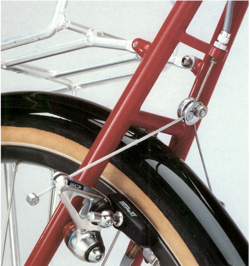
Sattelstrebenbereich Modell WL mit Gepäckträgerbefestigung und Bremszug-gegenhalterbügel mit Einstellschraube, Bremsen Deore XT
