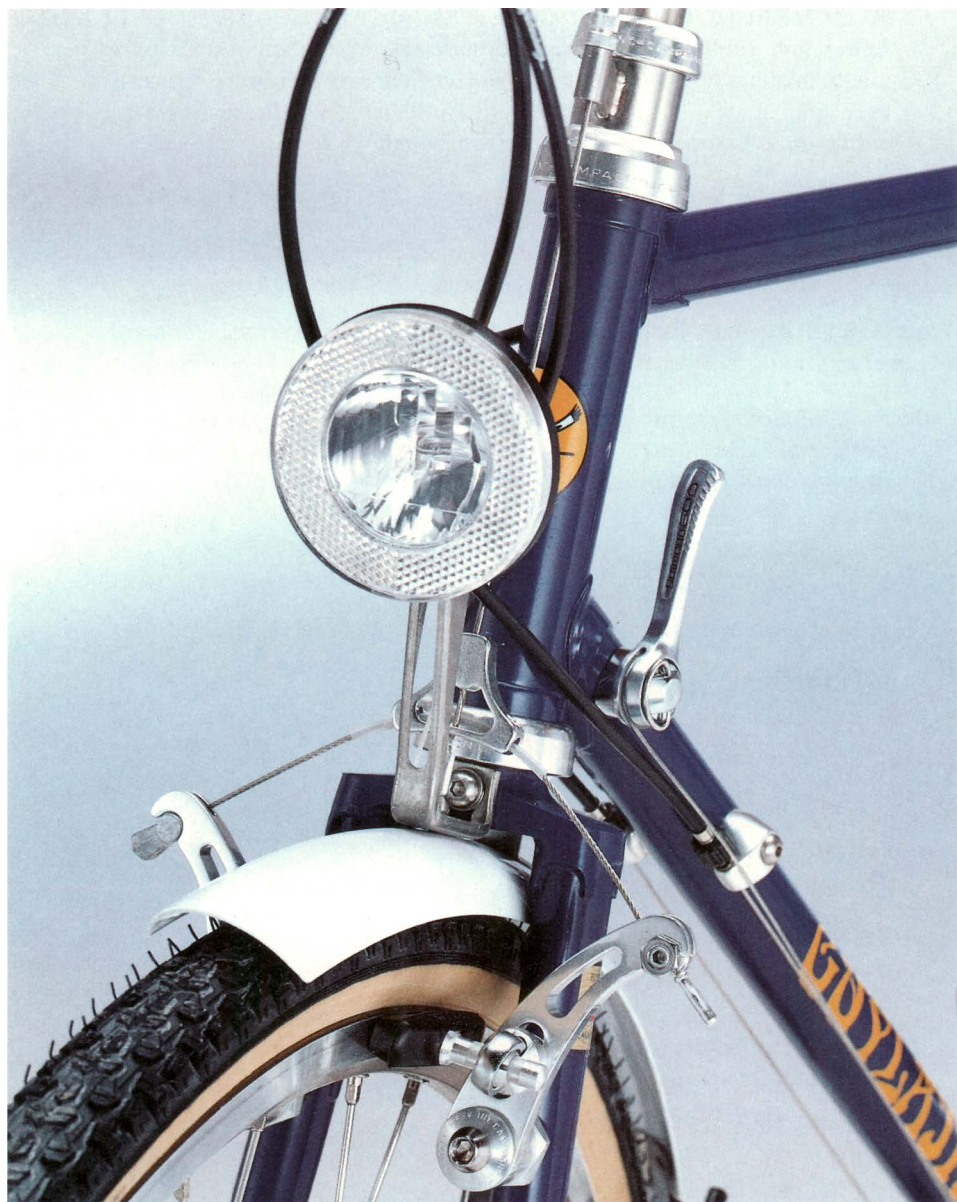
Reiserad GUYLAINE WL: Steuerkopfbereich mit Steuersatz Campagnolo Con-tax mit GUYLAINE Bremszuggegenhalter, Bremsen Campagnolo Record OR mit Shogun Zugdreieck, Scheinwerfer Union U9350H (vorn am Unterrohr Fernbedienungshebel für Walzendynamo)
