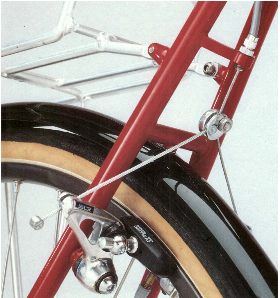
Reiserad WL: Sattelstrebenbereich mit Gepäckträgerbefestigung und Bremszuggegenhalterbügel mit Einstellschraube, Bremsen Deore XT M732
