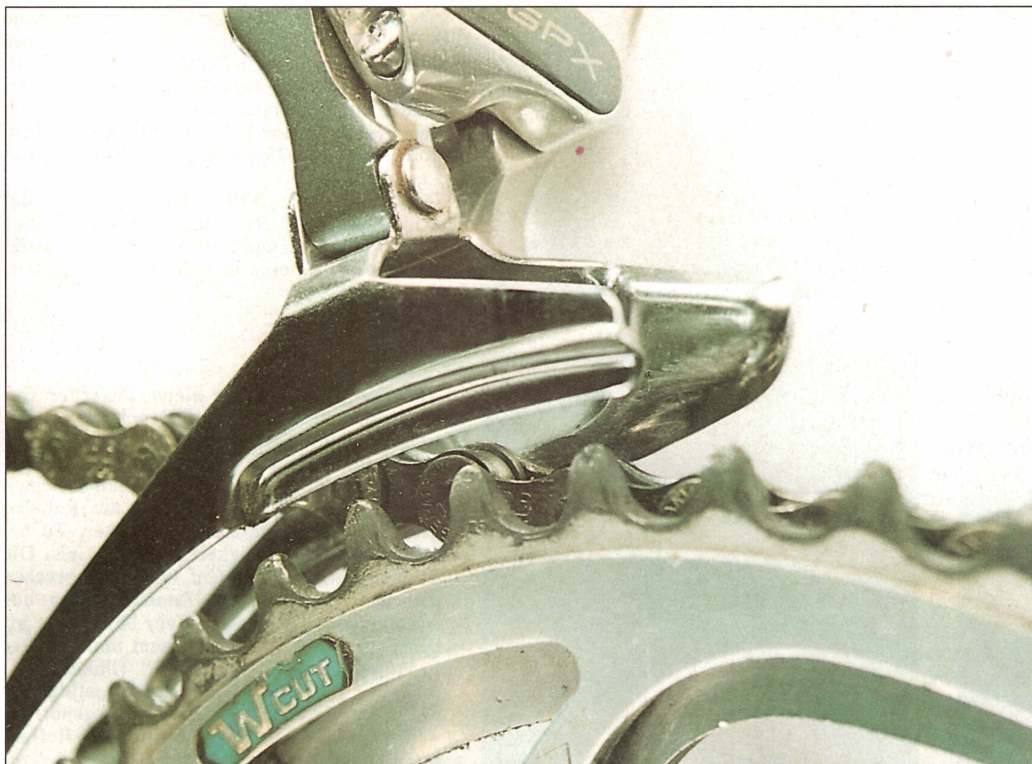
Extrem ausgeformt und nur für schmale Ketten geeignet: der Suntour GPX-Werfer.
