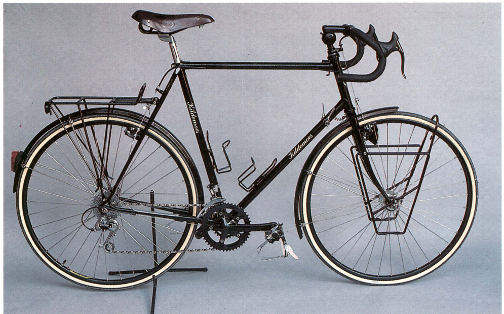
Kildemoes MK I besticht durch klassisches Aussehen und Feinheiten im Detail, so zum Beispiel die Half-Step-Übersetzung und die radialen Einspeichungen.
