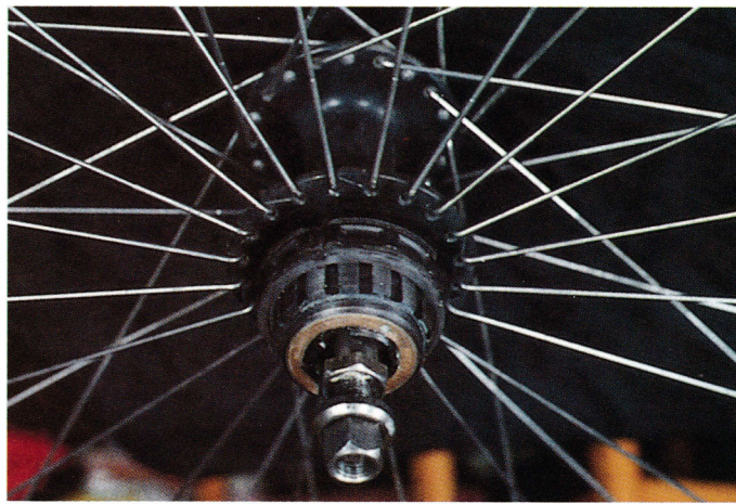
Radialspeichung auf der Zahnkranzseite, Vierfachkreuzung links – das gibt ein sehr haltbares Hinterrad. Möglich ist der Trick aber nur mit soliden Hochflanschnaben.
