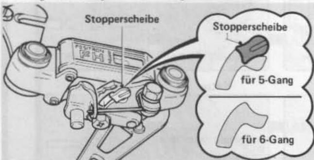
① Montieren Sie die Kettenschaltung mit der Halterschraube am Rahmen.
