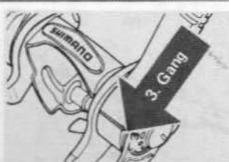
⑧ Anbringung des Kabels an der Schaltung
