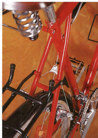
Detail-Perfektion: Die Anbringung des Gepäckträgers und die Führung des Bremszuges überzeugen.
