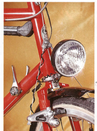
Halogen-Licht (Fabrikat Elio) und Cantilever-Bremsen von Weinmann dienen der Fahrsicherheit.
