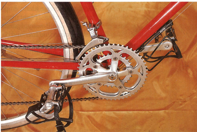
Ein Kettenschutz fehlt, ansonsten aber stimmt die Antriebseinheit (Dreifach-Tretlager und Touring-Pedale).
