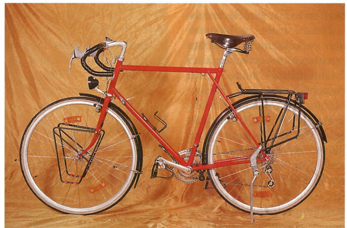
Die Montage des Ständers am Hinterbau verleiht dem Velo auch im beladenen Zustand genug Standfestigkeit.
