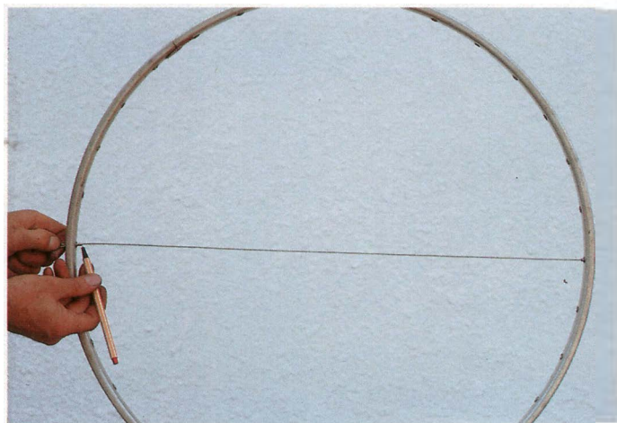
2. So messen Sie das Felgenmaß "Di": Bremsinnenzug halbwegs stramm durch die Felge führen und Innenkante des aufgefädelten Speichennippels markieren. Dann Abstand auf Bowdenzug ausmessen und 10 mm für die Nippelschaftlänge hinzuzählen.
