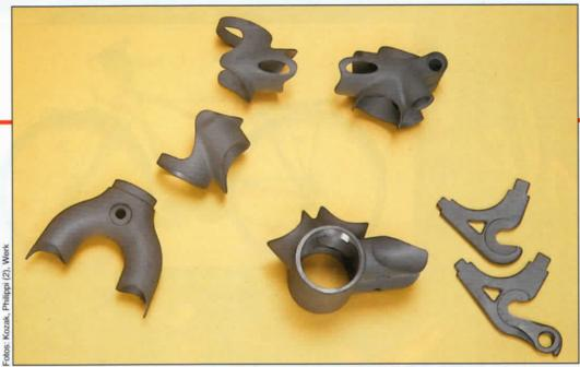
beim Verbinden der Rohrenden neutralisiert die durch das Vergüten des Stahls erworbene Festigkeit. Die Endfestigkeit in den beim Löten erwärmten Muffenzonen liegt bei der Verwendung von Messinglot nach dem Fügevorgang gut 30 Prozent niedriger als zuvor.
