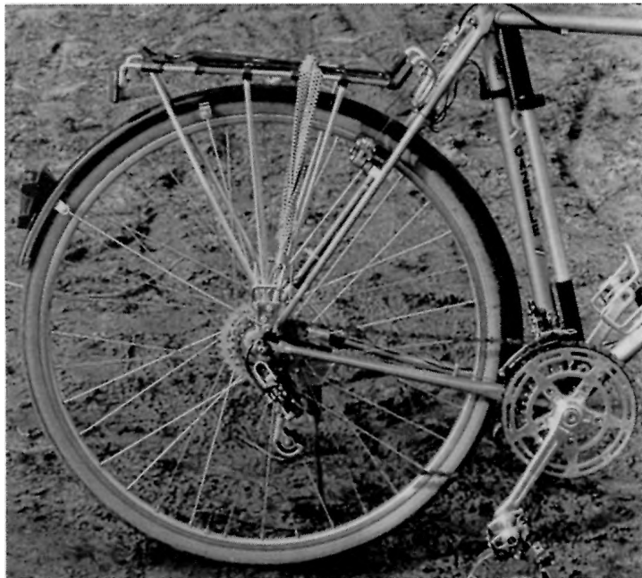
Die Extremübersetzung (Stronglight 99, Regina Oro) mit Duopar-Schaltung.
