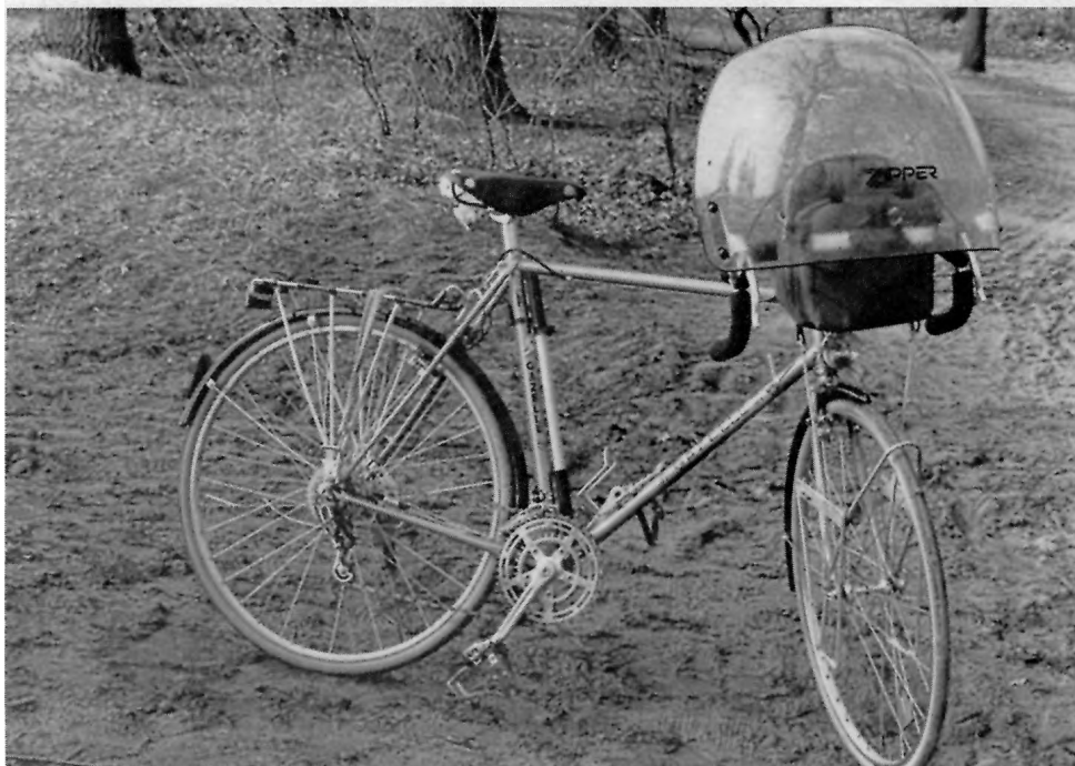
Das komplette Rad mit Zipper (20 Prozent Krafteinsparung bei hoher Geschwindigkeit, keine tränenden Augen bei schnellen Abfahrten u. a.).
