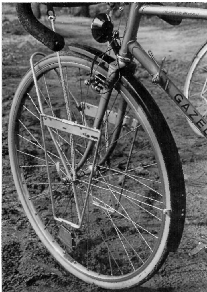
Das Gepäck läßt sich tief anbringen — das verbessert die Fahreigenschaften (Geradauslauf) erheblich.
